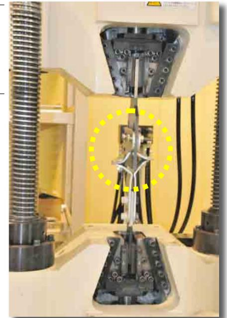
最大数値計測後、約21.0KNの補強耐力を推移し続けることが可能であることが確認された。
